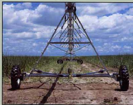
Torre em posição de Rebocagem
